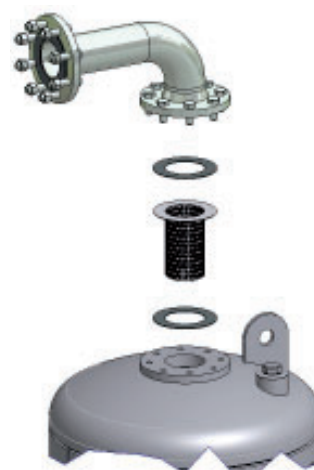
Demontáž prachového sitka
